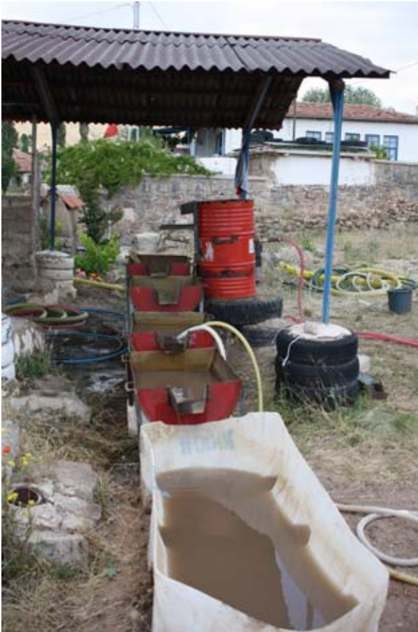
řekil 105. Flotasyon cihazı. (11dpcc0214)
